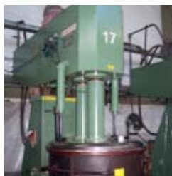
Moinho com tampa – fechamento hidráulico
